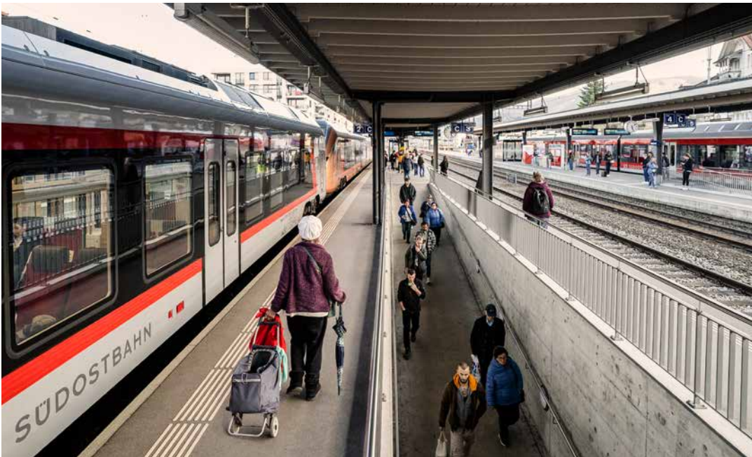
Perronzu- und abgang am Bahnhof Wattwil. Taktill-visuelle Markierungen entlang der Perronkante.
